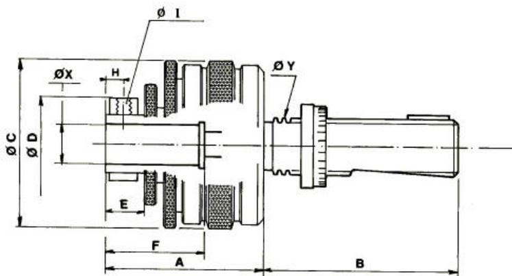
Attacco macchina a vite trapezoidale (DIN 6327) – Con ghiera di regolazione della vite trapezoidale.
