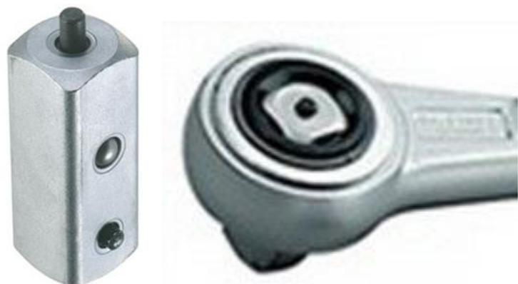
La Casa Gedore per rendere perfetto il bloccaggio del suddetto quadro fra leva a cricco e bussola, ha inserito nel quadro stesso un dispositivo a pulsante. Al momento dell'innesto sulla leva, è sufficiente premere il pulsante del raccordo, il quale liberando la sfera permette il giusto posizionamento: rilasciando il pulsante il bloccaggio risulta perfetto nella sua tenuta.
