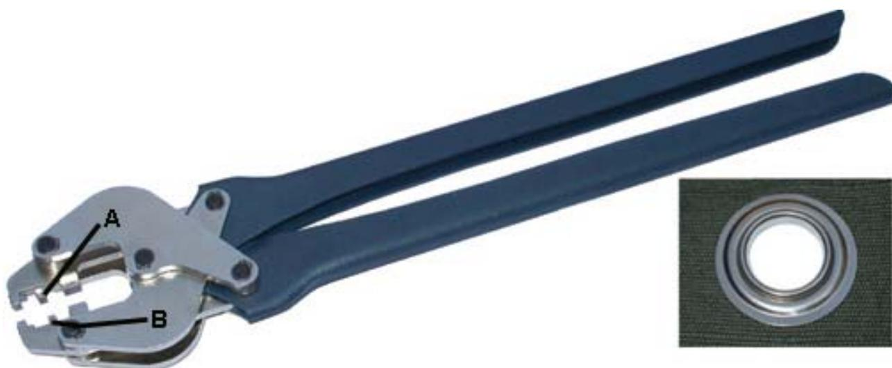
Tipo per occhielli giganti a grande capacità di pressione (1 Ton. circa). Modello brevettato, a doppia leva, per ridurre lo sforzo d'uso. Chiusura parallela delle ganasce con punzoni e matrici intercambiabili. Testa in acciaio temprato e impugnatura in robusta lamiera. Ideale per teloni, coperte, vele ecc. di forte spessore e robustezza.
