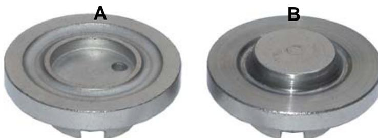
Coppie punzoni e matrici Art. 455GF in acciaio temprato per uso con pinza Art. 455 GE. Il diametro della matrice e del punzone, corrispondono al diametro del foro dell'occhiello da pressare. **Gli occhielli devono essere conformi alla norma DIN 7332.**
